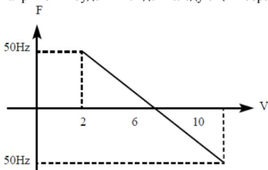
Пример 2: управляющее устройство подает сигнал 4-20mA, и управляет работой преобразователя частоты. Рабочая частота 100-0Hz.
