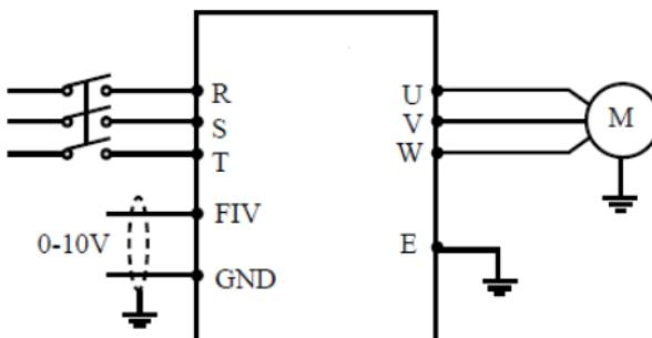
Примечание: 0-10V сигнал непосредственно введен через FIV, чтобы управлять рабочей частотой преобразователя частоты.
