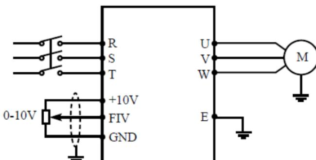
Примечание: сигнал напряжения FIV введен через внешний потенциометр (10 КΩ), чтобы управлять рабочей частотой преобразователя частоты.
