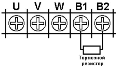
улучшить тормозящую способность встроенного тормозного блока и двигателя, который тормозят. Метод подключения тормозного резистора к преобразователю частоты до 1.5 кВт смотрите ниже:
