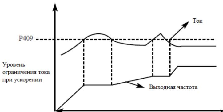
Величина тока перегрузки 100% соответствует номинальному току преобразователя частоты (т.е. предельно возможной величине параметра P210 в диапазоне допустимых значений). Защита отключена при P409=0.
