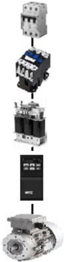
**Электропитание:** Проверьте напряжение питания преобразователя частоты, совпадает ли оно с напряжением сети AC, чтобы избежать вывода из строя преобразователя частоты.
