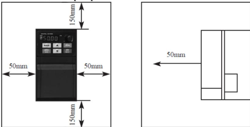
**Установка нескольких преобразователей частоты в одном шкафе:**
