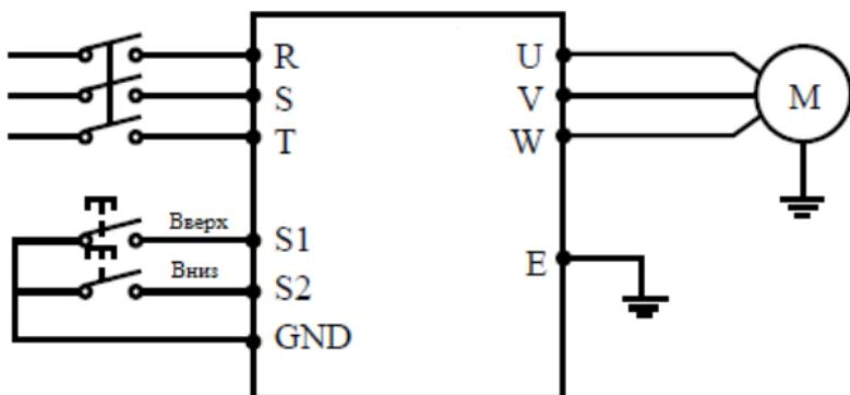
Параметр: P317=15, функция ВВЕРХ назначена на терминал S1; P101=4, способ установки частоты - способ вверх/вниз; F318=16, функция ВНИЗ назначена на терминал S2.
