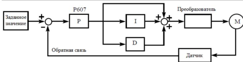
При использовании PI или PID – законов регулирования допускается возможность возникновения ошибки регулирования с величиной до  $\pm 10\%$  от значения максимального сигнала обратной связи.
