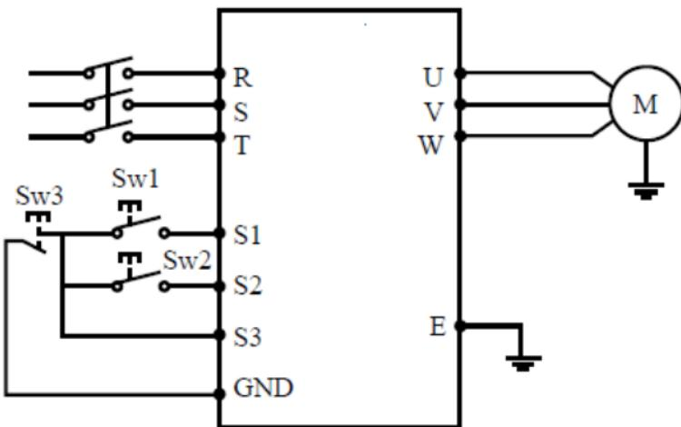
В качестве входов для внешнего сигнала здесь используются Sw1, Sw2, и Sw3. Контакт Sw3 нормально замкнутый.
