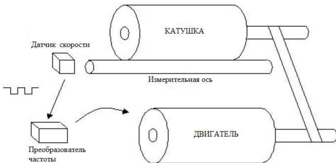
Рисунок FB-2 Применение стопа на фиксированной длине
